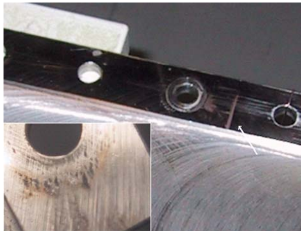
Kuva 8. Levyissä näkyi kulumajälkiä ja ruosteläikkiä. Nuolen osoittama ruosteinen raita on syntynyt pulttiliitoksen päähän. Vasemmalla alhaalla lähikuva pienen levyn päästä.
