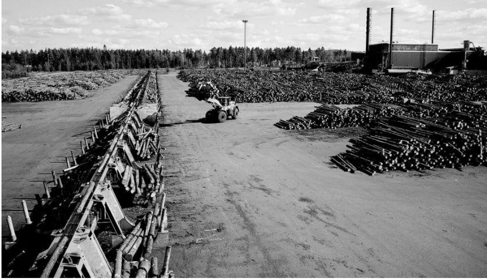
Kuva 1 Lajittelukoneen lokeroita ja sahan tukkikenttä, jonne kunkin tukkiluokan tukit varastoidaan ennen sahausta. Kuvälähde: KnowTimber v3.1 (2007)
