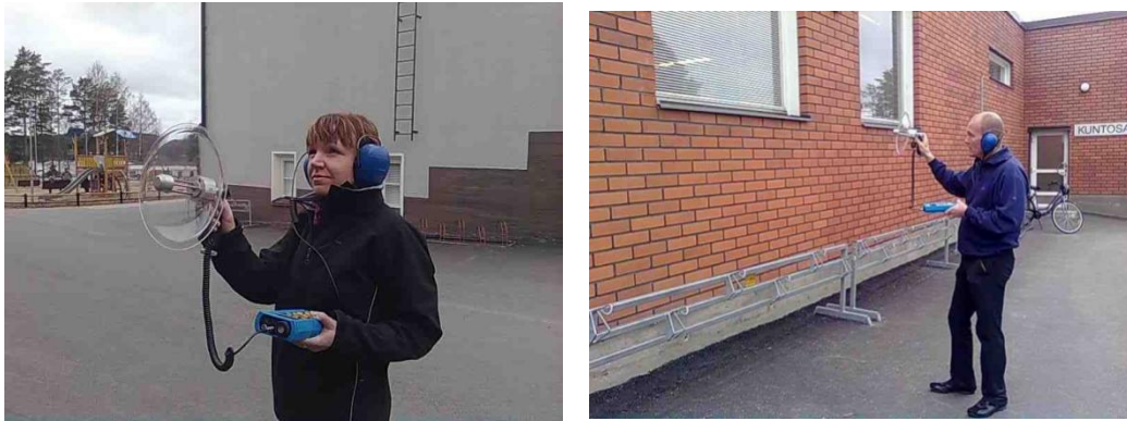
Kuva 50 A-B: ultraäänen kuunteluun/peilaukseen perustuvan laitteiston koekäyttöä Kuopion Vehmersalmen koululla 29.4.2010.
