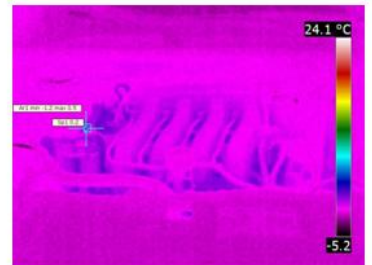
Kuva 71 A-F: auton moottorin jäähtymisen havainnollistavat lämpökuvat klo 9-16.
