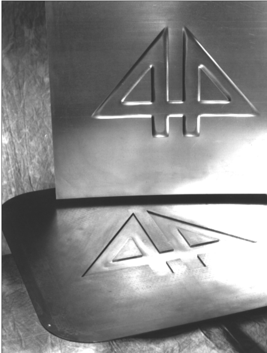
Kuva 11. Levyrakenteinen logomuotti ja sillä muovattu kappale.
