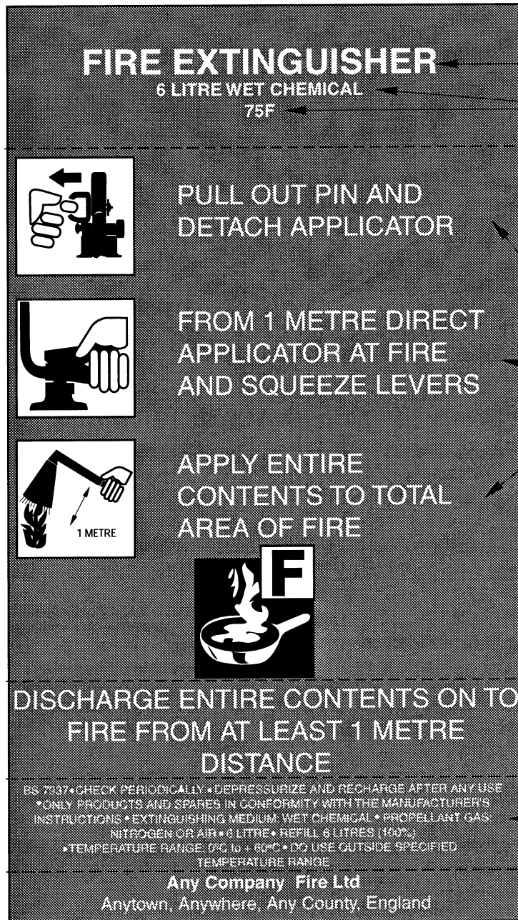
Kuva 3. BS 7937:2000:n F-luokituksen mukainen sammuttimen etiketti [9].
