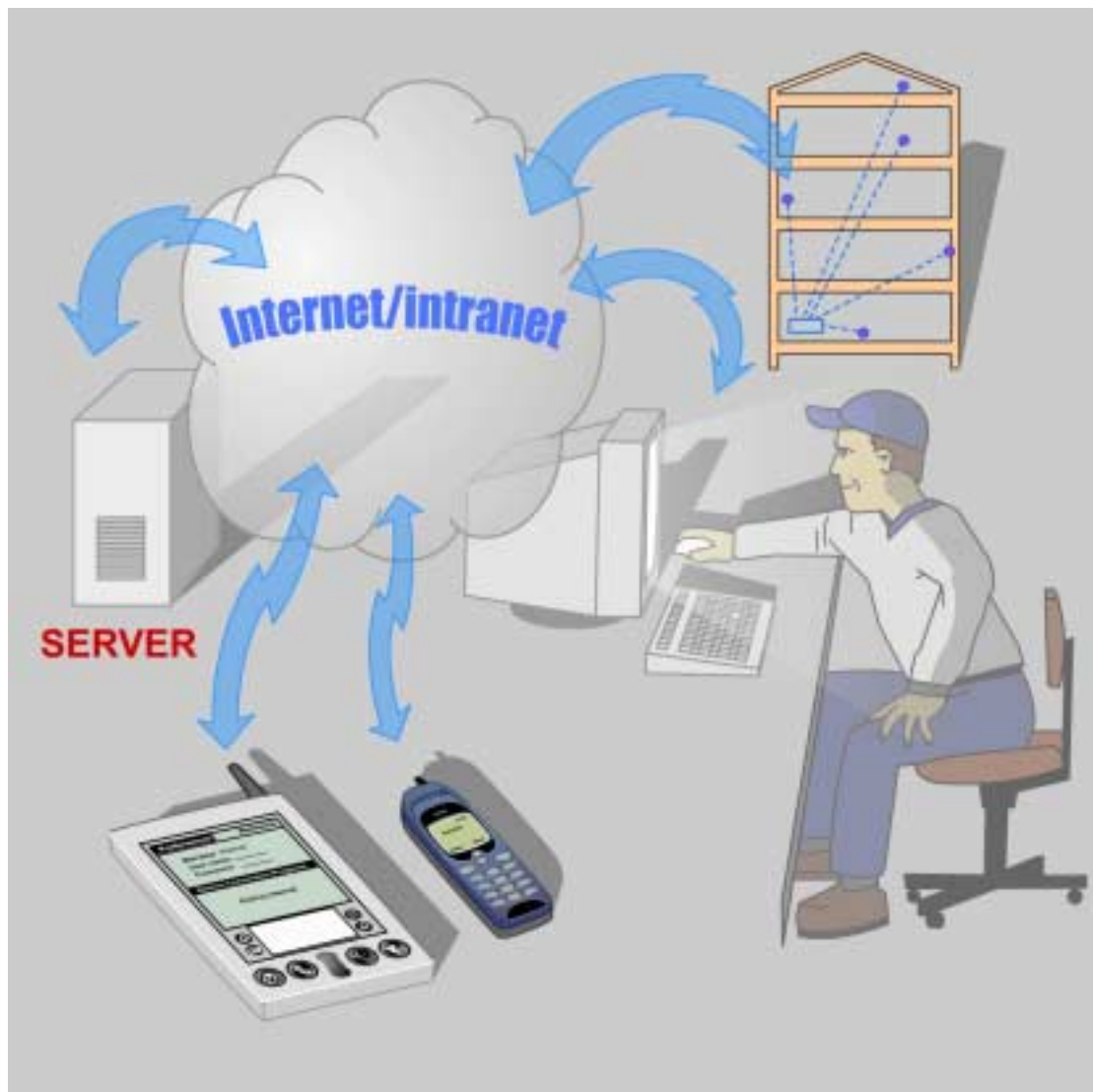
Kuva 1. WebDian toimintaperiaatteen kuvaus. Oikealla näkyvä liitäntä rakennusten taloteknisiin järjestelmiin kuvaa WebDian tulevia kehitysnäkymiä.
