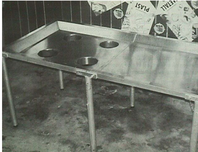
Kuva A1. Kuudessa ruotsalaisessa kunnassa tehdyssä tutkimuksessa käytetty lajittelupöytä. Pöydässä olevien neljän aukon alapuolelle asetettiin säkit; näihin lajiteltiin yleisimmät materiaalit. Muut materiaalit lajiteltiin pöydän ympärillä oleviin astioihin.
