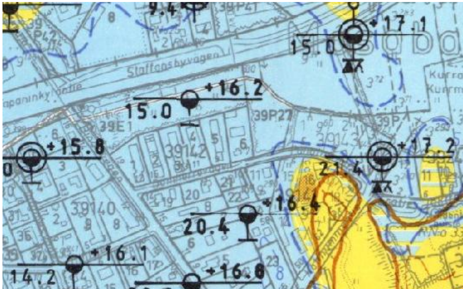
Kuva A1. Esimerkki mittauspisteiden sijainnista suunnitellulla kaava-alueella (yläkuva). Keskil alueella mittauspisteiden määrää on harvennettu, koska sen lähialueella pohjasuhteet (alakuva) ja väylän ominaisuudet eivät muutu.
